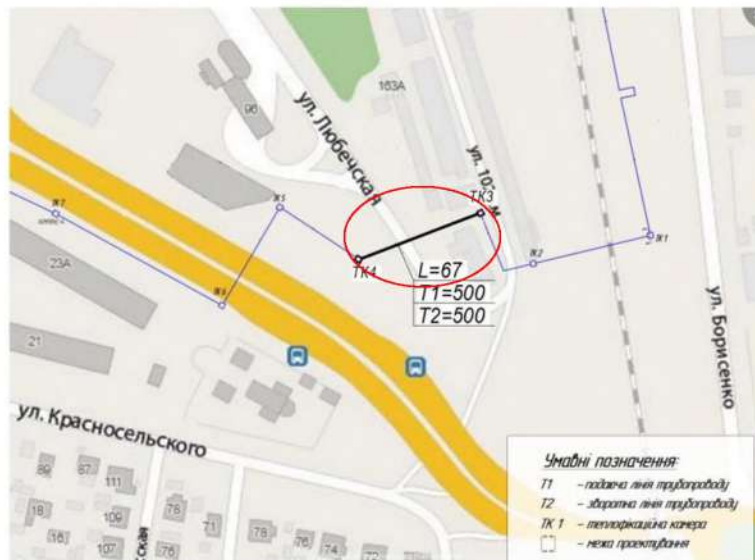
Рис 1. Виконані роботи з реконструкції магістральної теплової мережі від ТК1 до ТК19 в мікрорайоні «Масани».
